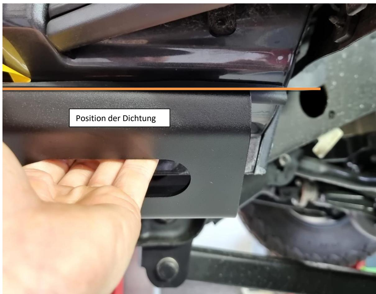
3. Nachdem die Dichtung Aufgeklebt wurde kann der Aluminium Außen teil Aufgelegt werden.
